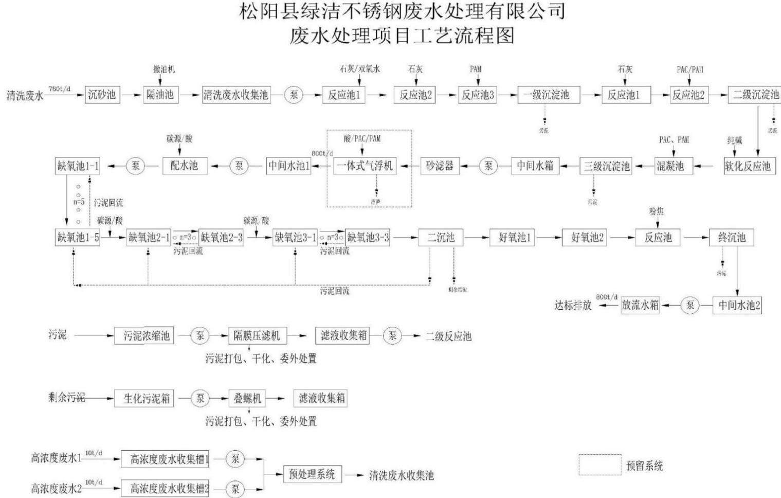
图 4.1.2-1 项目工艺流程图
